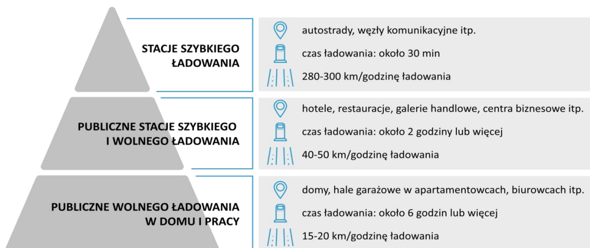
Rysunek 24 Mix infrastruktury ładowania pojazdów elektrycznych
